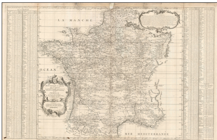
Franciaország első országos topográfiai felmérése alapján készült háromszögelési hálózatokat bemutató geodéziai térképe, 1744. (OSZK Térkép-, Plakát- és Képtár – Raktári jelzet: TR 2.927)
